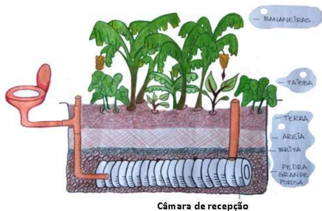
Figura 04 – Corte esquemático de um Tanque de Evapotranspiração. Fonte: < http://permaculturailimitada.com.br/fossa-bacia-de-evapotranspiracao/ >. Acesso em: 10 jun. 2019.
