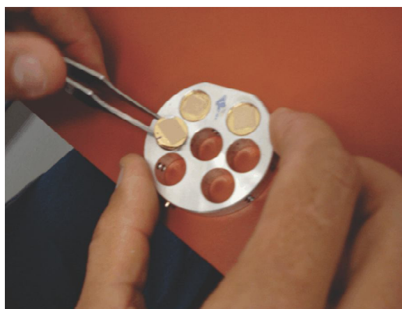
Figura 1. Fotografia das amostras após o recobrimento com ouro. Fonte: Arquivo pessoal da autora (Elisângela Gorete Fantinel, 2014).
