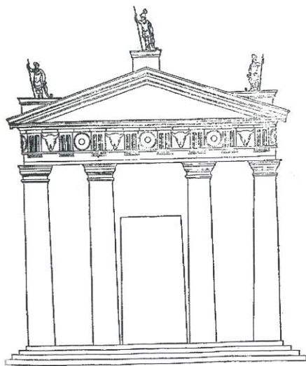
Templo tetrastilo segundo Vitrúvio, desenho de Andrea Palladio, edição de De architectura , Veneza 1556, tradução D. Barbaro
