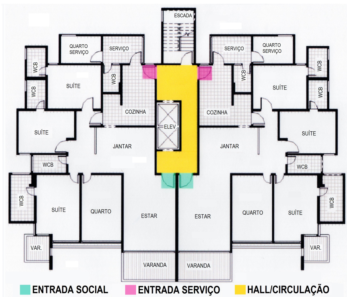
FIGURA 4 – Planta baixa pavimento tipo do Edifício Dandara (1997)
