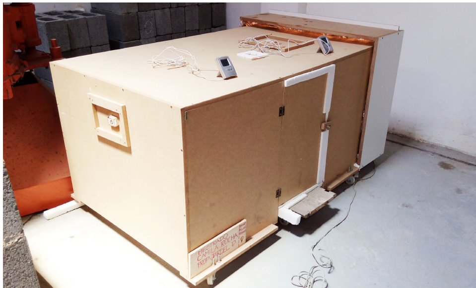
FIGURA 1 – Câmara térmica projetada e produzida para a realização dos ensaios.
