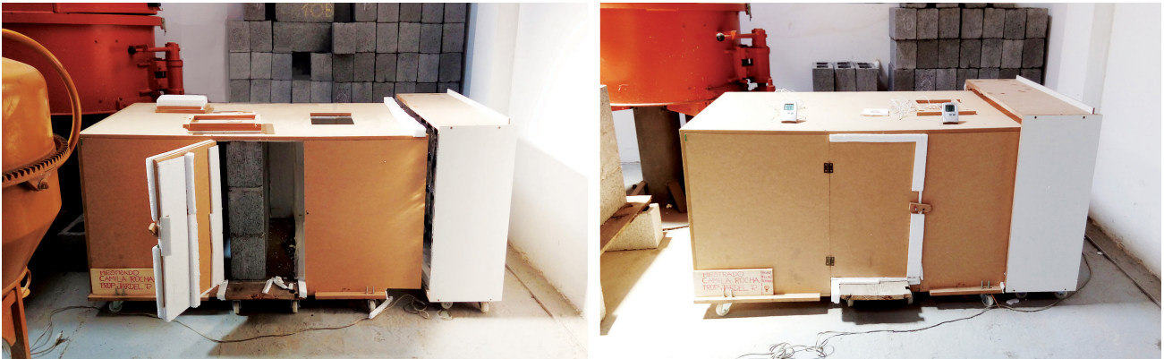
FIGURA 4 – Demonstração da câmara de transferência de calor, aberta e fechada, em operação no laboratório.
