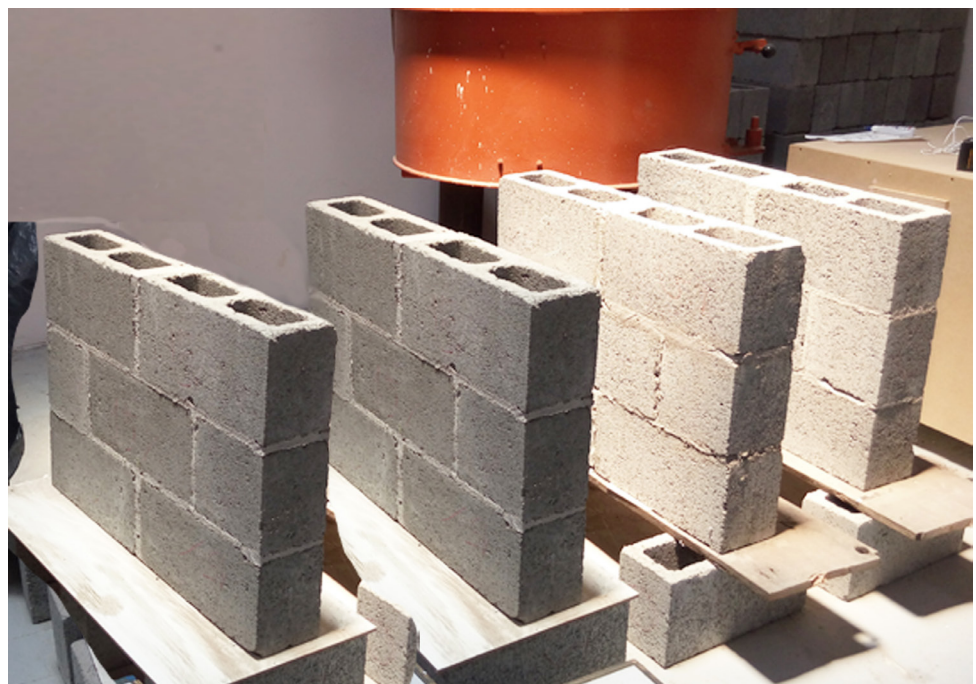
FIGURA 5 – Painéis em alvenaria em blocos de concreto utilizados na pesquisa.
