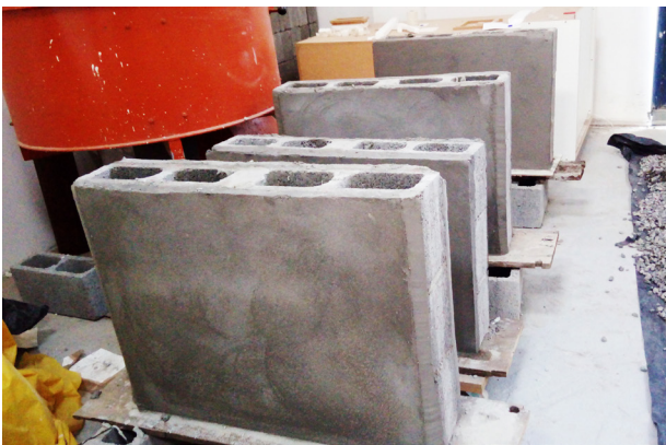
FIGURA 7 – Demonstração dos painéis ensaiados de alvenaria de bloco de concreto após acréscimo da argamassa de revestimento.
