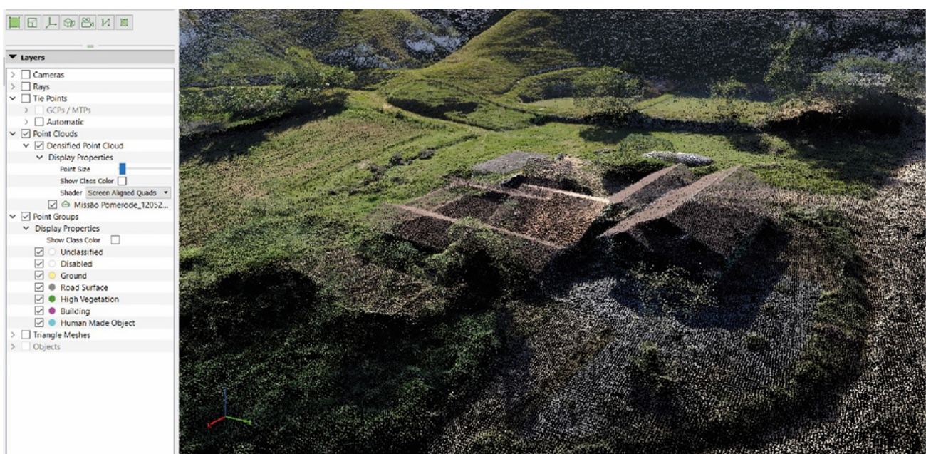
FIGURA 5 — Detalle nube de puntos de aeroplano en el software Pix4D.
