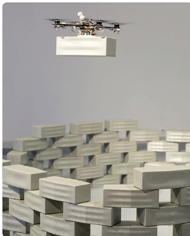
FIGURA 6 — VANT como actores en el proceso constructivo.
